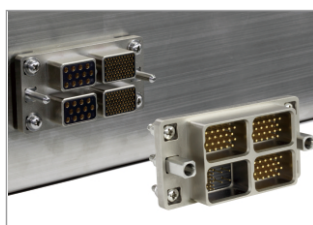
"Плавающие", самоцентрирующиеся модульные соединители серии J29M Плавающие величины: 3 мм по оси, \pm 1 мм по радиальному направлению
